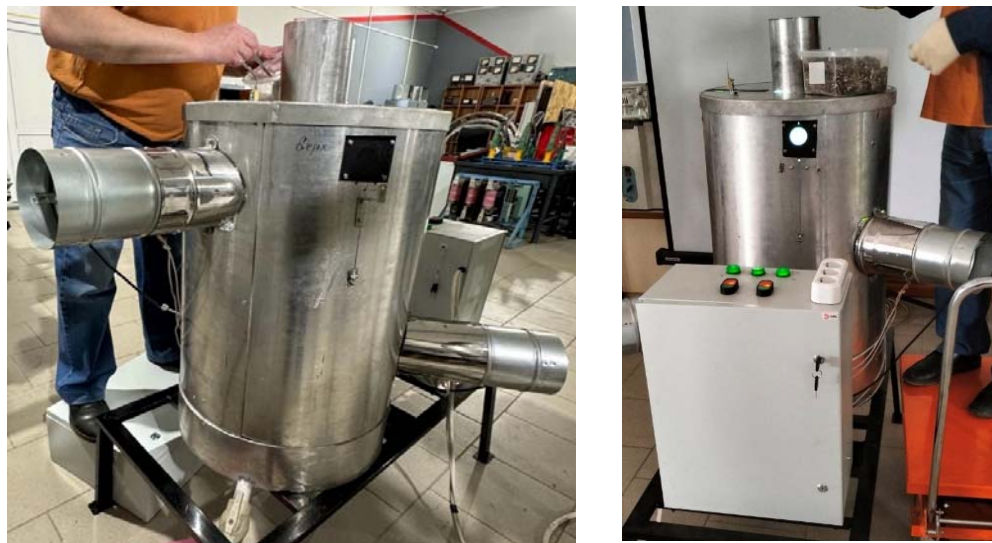
Рис. 1. СВЧ-установка непрерывного действия с замедляющей системой для переработки слизистых субпродуктов КРС
