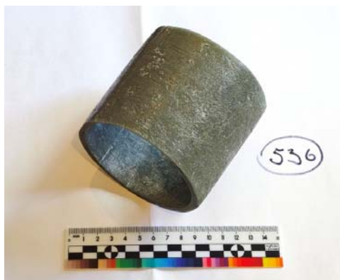
Рис. 2. Фрагмент фотополимерной трубы Ду 80, полученный стационарным пултрузионным модулем
